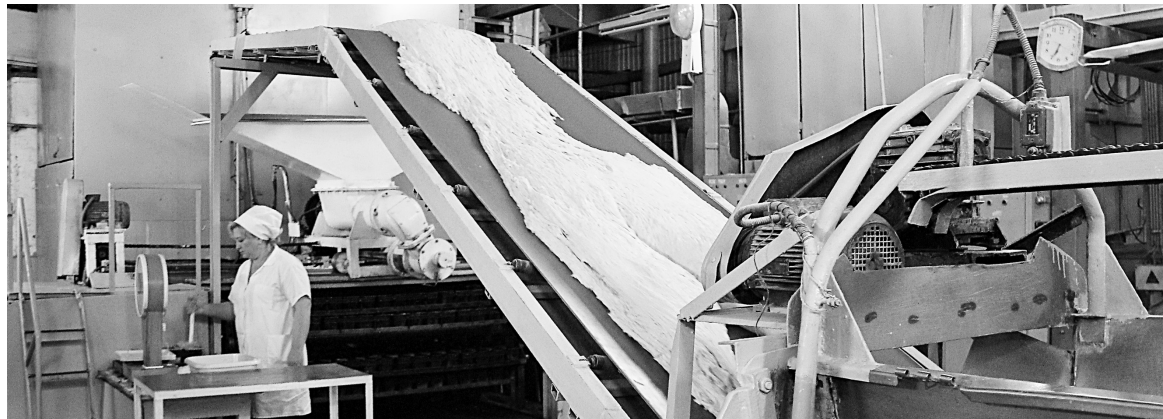
Готовое тесто автоматически подается в тестоделитель-укладчик. Бригадир М. Сухорукова готовится смазывать формы
